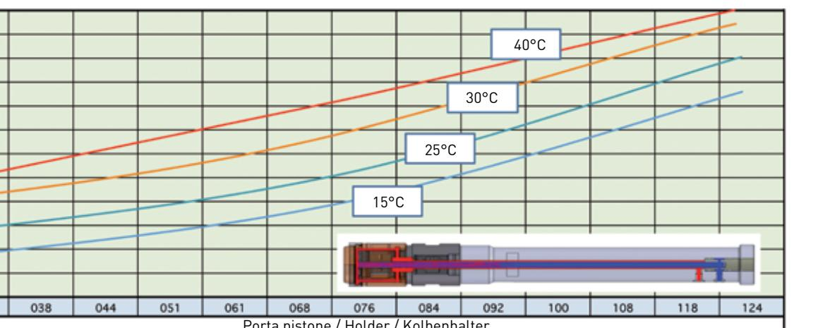
È estremamente importante la portata d'acqua per il raffreddamento del pistone. Grazie al particolare circuito brevettato, la temperatura di esercizio risulta essere molto bassa (vedi foto termografica).
